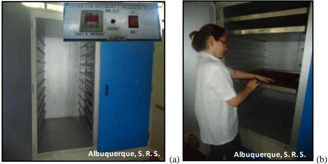
**Figura 21** - Estufa de aquecimento. (a) Imagem detalhada da estufa utilizada. (b) Verificação do estágio de secagem da polpa de Buriti.
