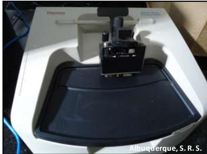
**Figura 26** - Equipamento de Infravermelho com Transformada de Fourier (FT-IR).
