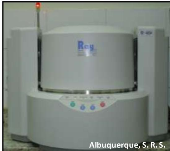
**Figura 29** - Equipamento de Fluorescência de raios-X por energia dispersiva.
