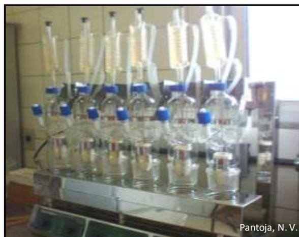
**Figura 23** - Extrator de *soxhlet*.
