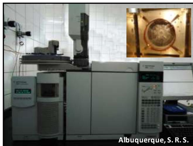
**Figura 30** - Equipamento de Cromatografia Gasosa/Espectrômetro de Massas.
