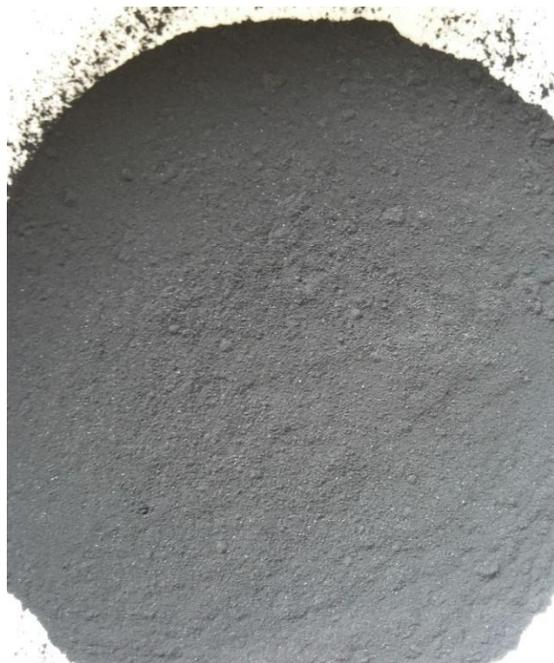
Figura 23 – Detalhe da cinza moída
