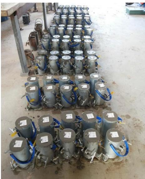
Figura 31 – Corpos de provas moldados após a execução de traço de concreto
