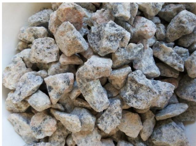
Figura 5 – Detalhe do agregado graúdo – brita 5/8"
