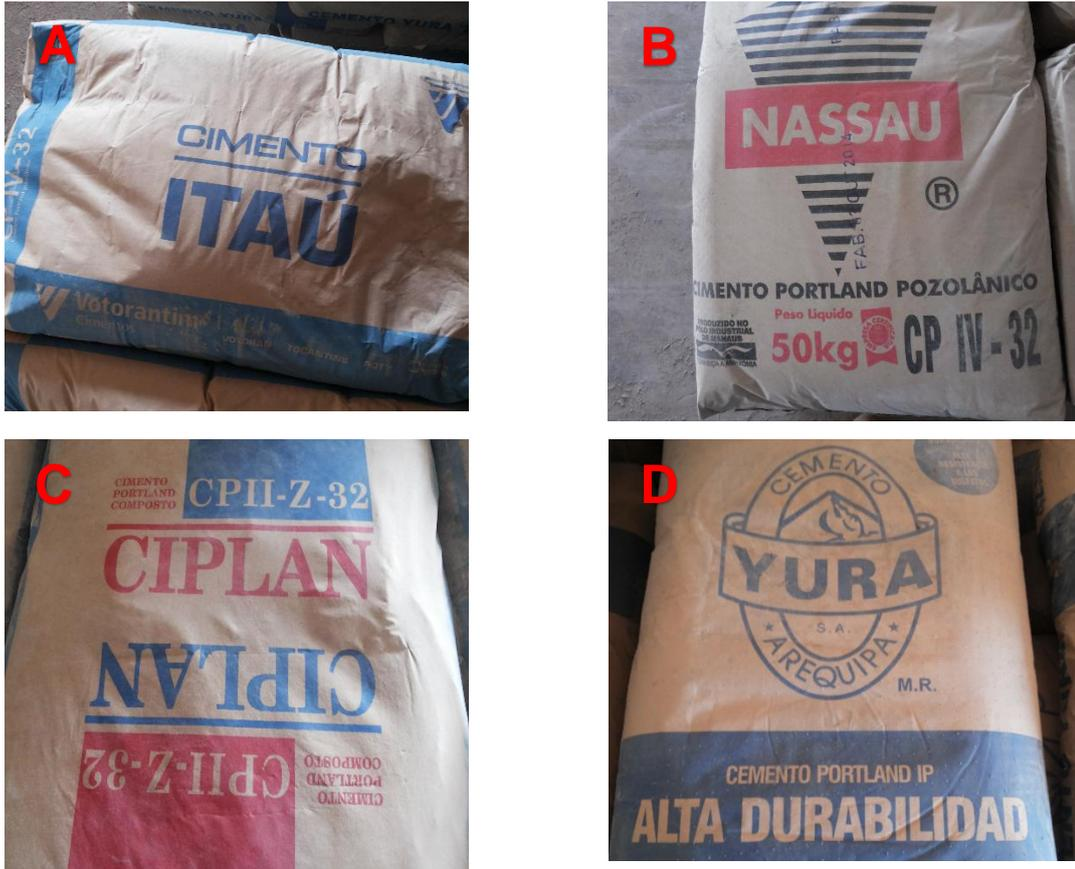
Figura 14 – Sacos de cimento Portland – A: cimento de marca ITAÚ, tipo CP IV e classe 32; B: cimento de marca NASSAU, tipo CP IV e classe 32; C: cimento de marca CIPLAN, tipo CP II – Z e classe 32; D: cimento de marca YURA, IP (tipo CP IV e classe 32)
