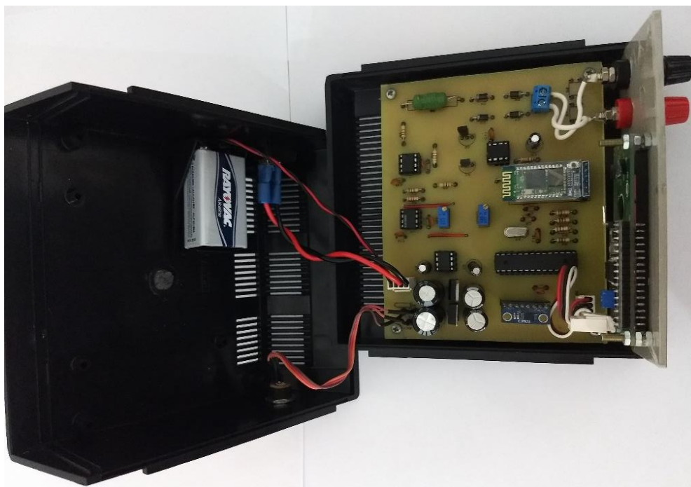
Figura 42 – Aspecto final da montagem do protótipo
