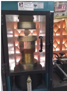
**Figura 25:** Teste de compressão diametral das amostras de argamassa.
