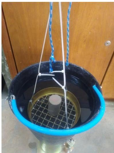
**Figura 41:** Pesagem das amostras de argamassa submersas.
