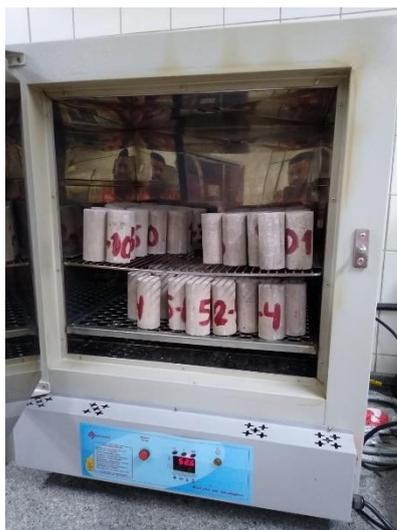
**Figura 40:** Secagem das amostras de argamassa em estufa.
