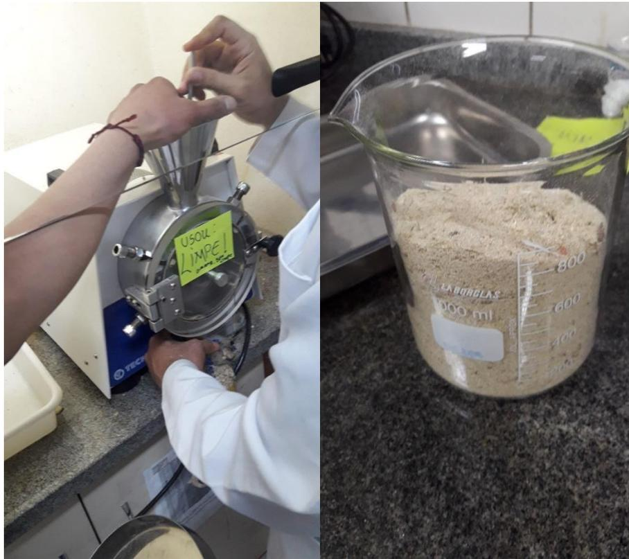
**Figura 27.** Cavacos de bambu sendo triturados no moinho/Bambu após triturado.
