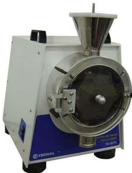
**Figura 16** – Moinho de facas utilizado para moagem dos cavacos de bambu.
