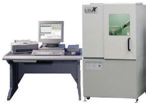
Figura 18 – Difratorômetro de Raios X.
