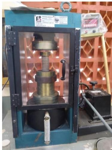
Figura 24: Teste de compressão axial das amostras de argamassa.
