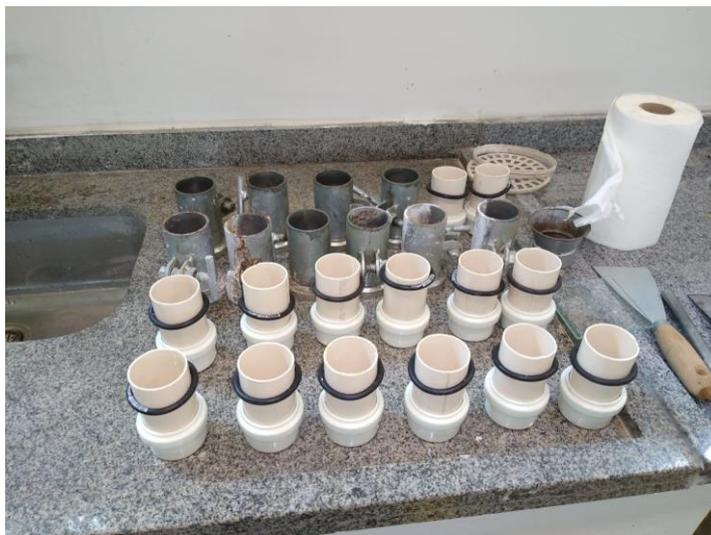
**Figura 22:** Preparo dos moldes para confecção dos corpos de prova.
