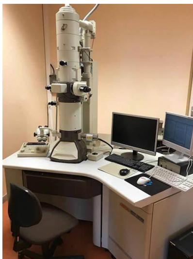
**Figura 20** – Microscópio Eletrônico de Transmissão.
