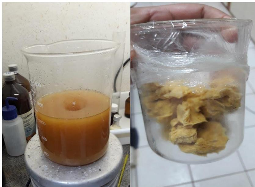
**Figura 28.** Deslignificação da polpa de bambu utilizando NaOH/Aspecto após deslignificação.
