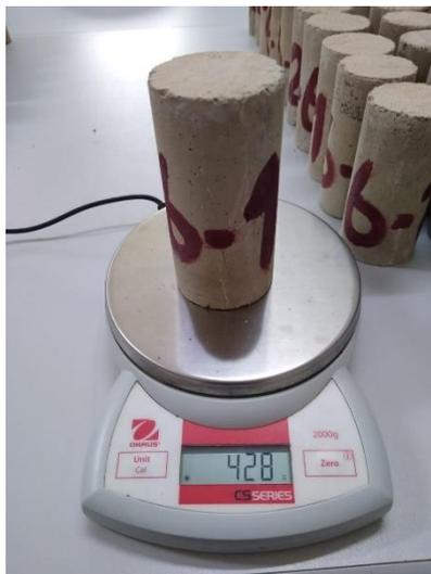
**Figura 39:** Balança para pesagem da massa seca e saturada das amostras de argamassa.
