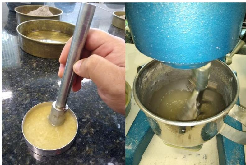
**Figura 21:** Maceração das fibras e diluição na água de amassamento.
