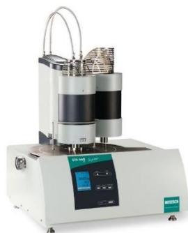
Figura 19 – Equipamento de Calorimetria Diferencial de Varredura (DSC)/Análise Térmica Diferencial (DTA).
