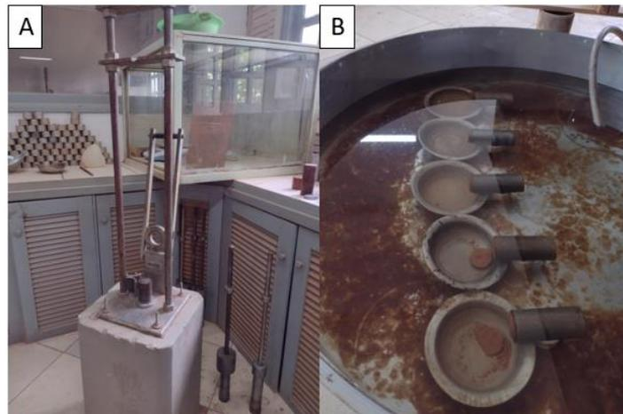
**Figura 12.** Realização do ensaio MCT. (a) Ensaio de Mini-MCV; (b) Ensaio de perda de massa por imersão.
