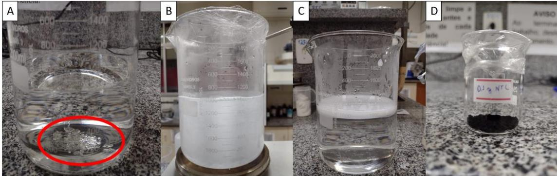
**Figura 15.** Solução para dispersão dos nanotubos de carbono. (a) Solução com o tensoativo Tween 80 (antes do agitador); (b) Solução durante o agitador magnético; (c) Solução após o período de 2 h no agitador; (d) Nanotubos utilizados na solução.
