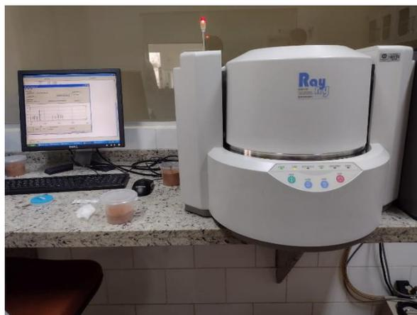
**Figura 13.** Equipamento para espectroscopia dispersiva de Raios-X
