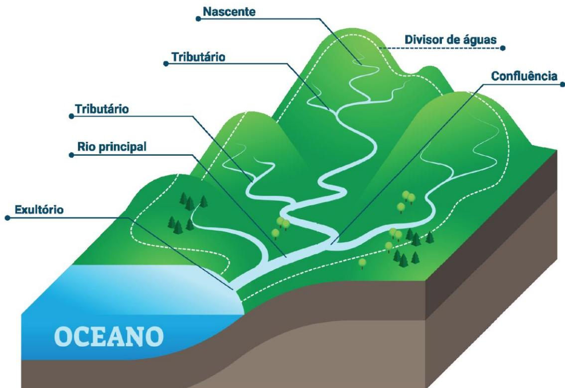
Figura 1: Elementos de uma bacia hidrográfica
