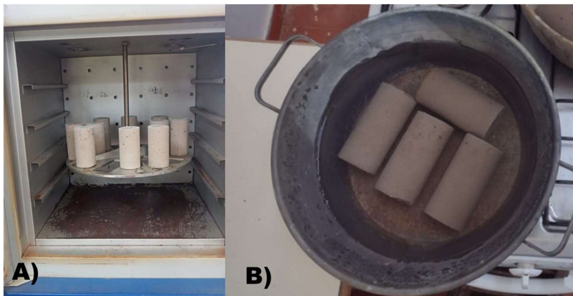
Figura 6: (A) CPs em processo de secagem em estufa; (B) CPs imersos em água a nível constante, em ebulição.
