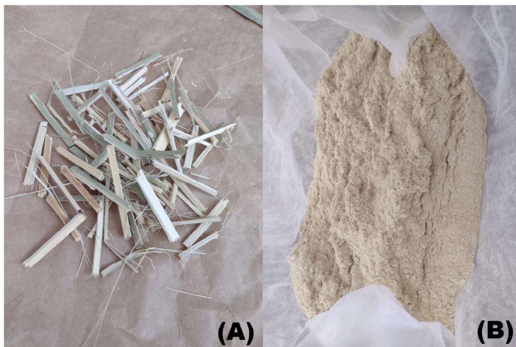
Figura 3 – (a) Bambu cortado para moagem; (b) bambu moído.
