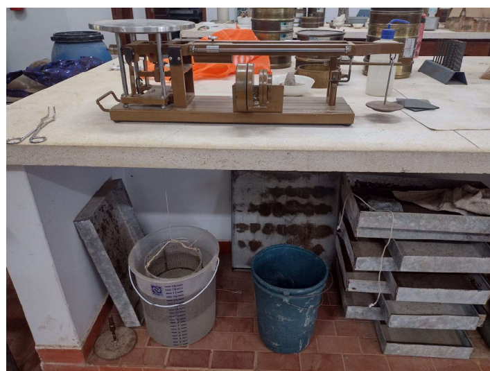
Figura 7: Balança hidrostática para realização de medição de massa imersa.
